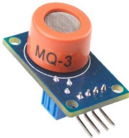
Рис. 4. Датчик-сенсор паров алкоголю MQ-3
