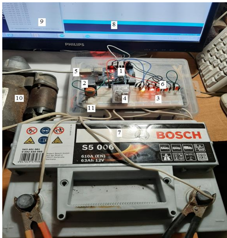
Рис. 8. Експериментальна перевірка блокувального пристрою з автомобільними акумулятором і стартером: 1 – плата Arduino Uno ; 2 – датчик-сенсор MQ3 ; 3 – макетна плата; 4 – модуль реле; 5 – USB кабель для з'єднання з комп'ютером; 6 – п'ять світлодіодів для індикації величини сигналу MQ3 ; 7 – автомобільний акумулятор; 8 – вікно програми Arduino ; 9 – монітор зі значеннями сигналу; 10 – стартер; 11 – ватка зі спиртом
