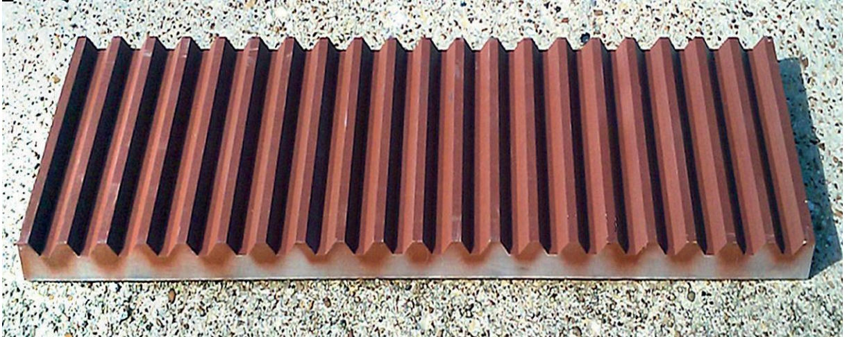
Рисунок Ж.2 – Пристрій перевірки профілометра за допомогою трапецієвидного профілю (амплітуда – 6 мм, основна довжина хвилі шорсткості – 12 мм)
