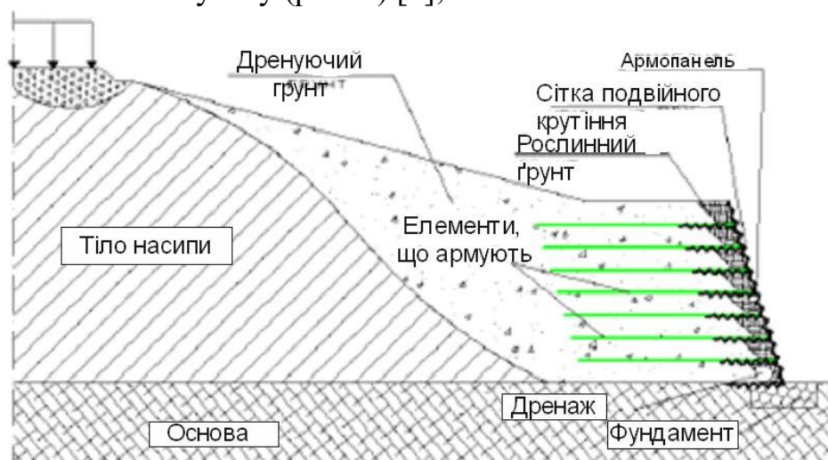
Рисунок 3 – Схема поперечного профілю насипу, посиленого армогрунтовою стіною системи Зелений Террамеш
