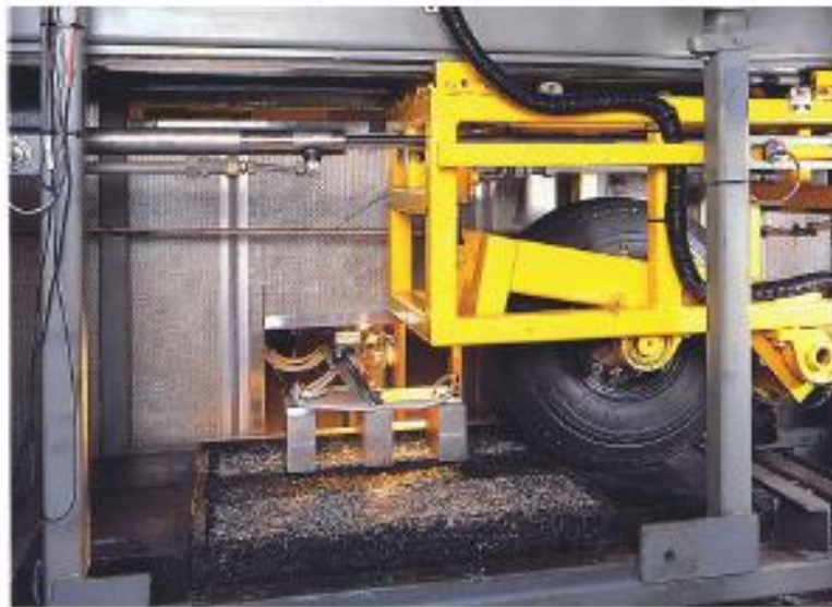
Рисунок 2 – Випробування асфальтобетонних плит розміром 700×500×60 мм колісним навантаженням 7 кН
