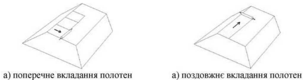
Рисунок 2 – Схеми укладання полотен при армуванні
