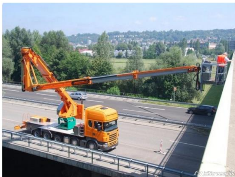
Рисунок 7 – Машина MBL-1750 Т (Германія) для обстеження мостів,
