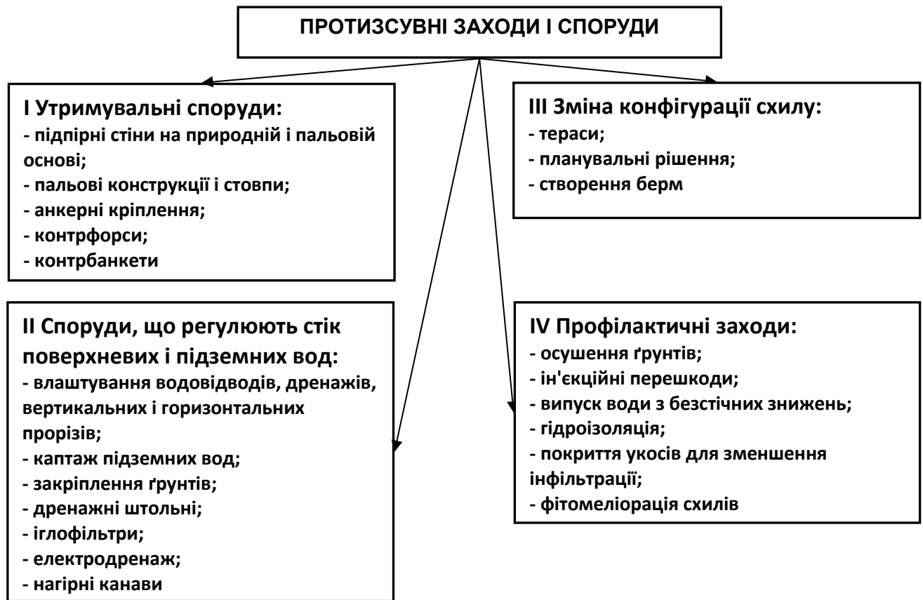
Рисунок 1 – Протизсувні споруди і заходи
