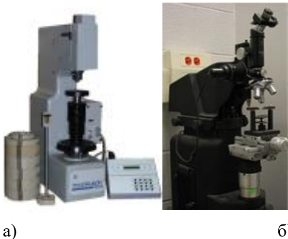
Рисунок 11 – Прилади для вимірювання твердості: а) Прилад для випробування твердості твердомір Бринелля; б) Прилад для визначення твердості за Віккерсом.
