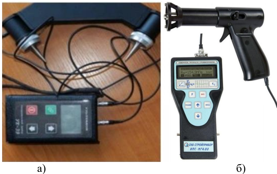
Рисунок 6 - а) Загальний вигляд приладу УК- 39 для ультразвукового методу при поверхневому «прозвучуванні»; б) Загальний вигляд ультразвукового приладу ИПС-МГ4.
