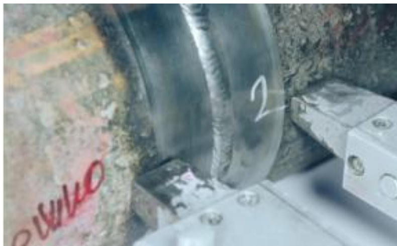
Рисунок 3 - Магнітопорошковий метод дефектоскопії
