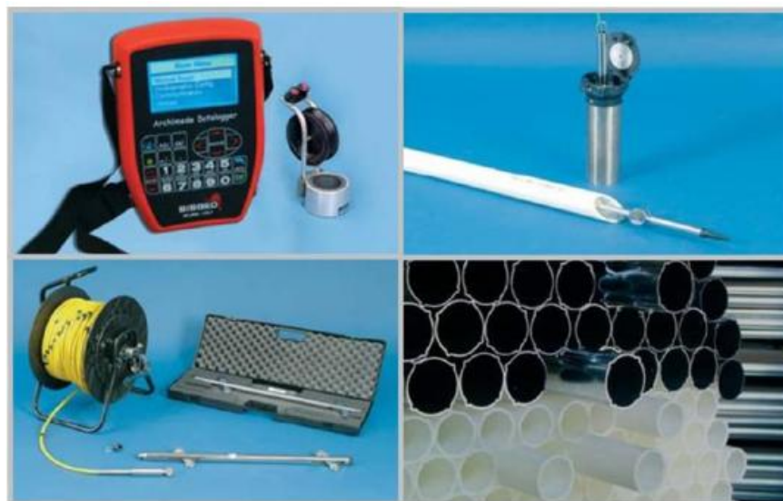
Рисунок 1 – Обладнання для контролю горизонтальних зсувів ґрунту
