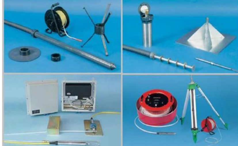
Рисунок 2 – Обладнання для контролю осадок ґрунту
