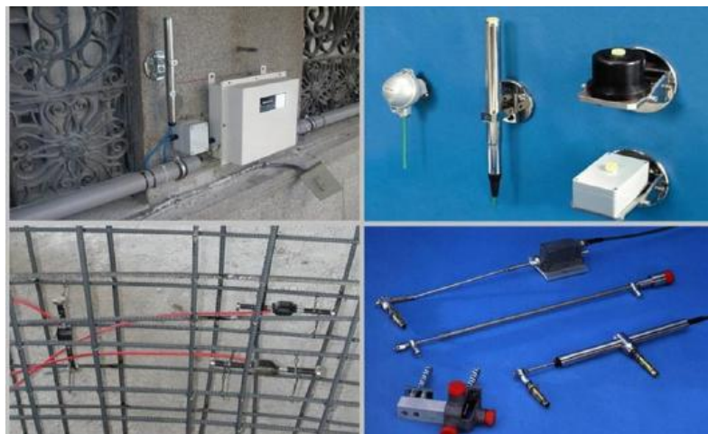
Рисунок 5 – Обладнання для моніторингу будівельних конструкцій фундаменту
