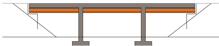
Рисунок 8 – Напів-інтегральний опорний міст
