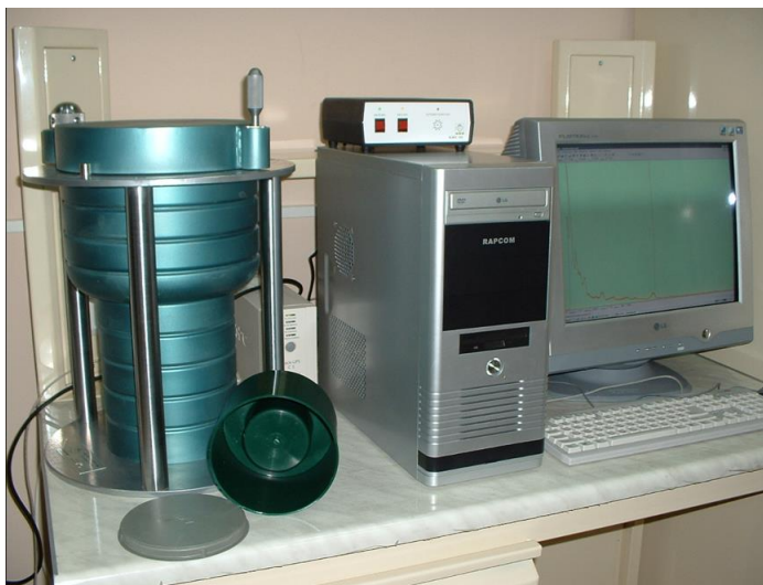
Рисунок 2 – Гамма-спектрометр СЕГ-001 "АКП-С"
