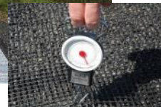
3. Додатковий притиск щіткою •Після висихання тест міцності приклеювання (9 кг на відрив)
