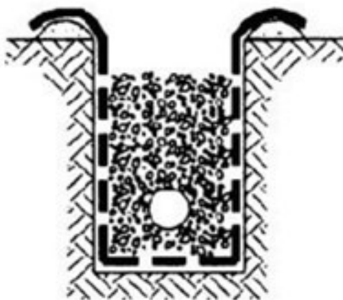
г) засипання дренажним матеріалом і ущільнення
