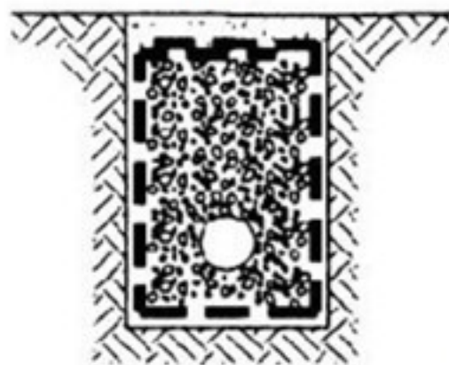
е) засипання ґрунтом і ущільнення
