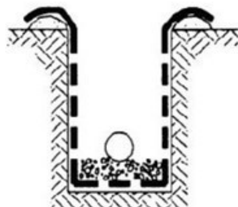
в) влаштування зернистої основи і вкладання дренажної труби
