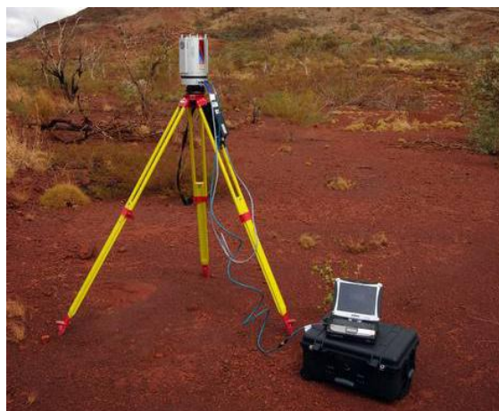
Рисунок 1 – Лазерний сканер з портативним комп'ютером
