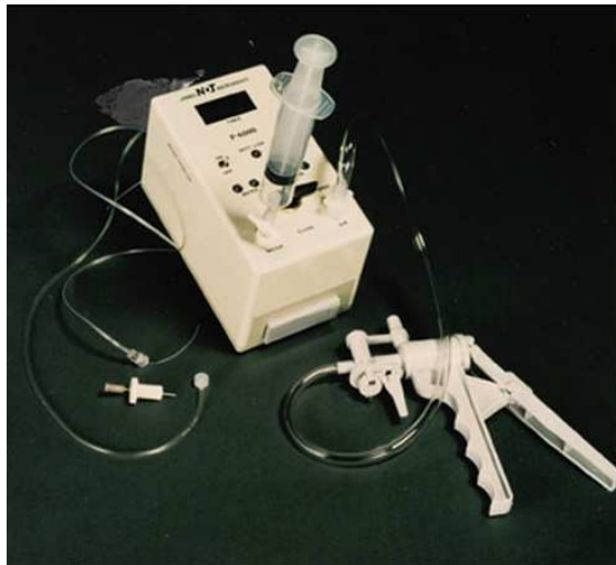
Рисунок 5 – Прилад для визначення водонепроникності цементобетону Porosiscop.
