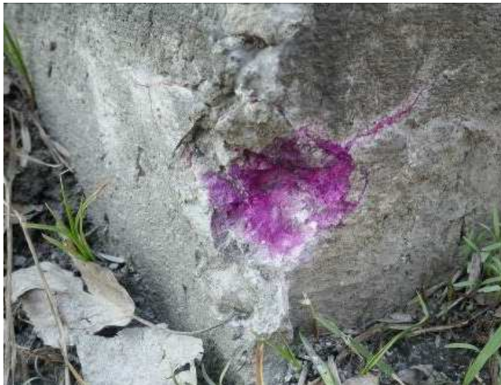
Рисунок 1 – Обробка однопроцентним розчином фенолфталеїну бетону відколотого кута фундаменту старого Карпівського пішохідного мосту у м. Харків через р. Лопань
