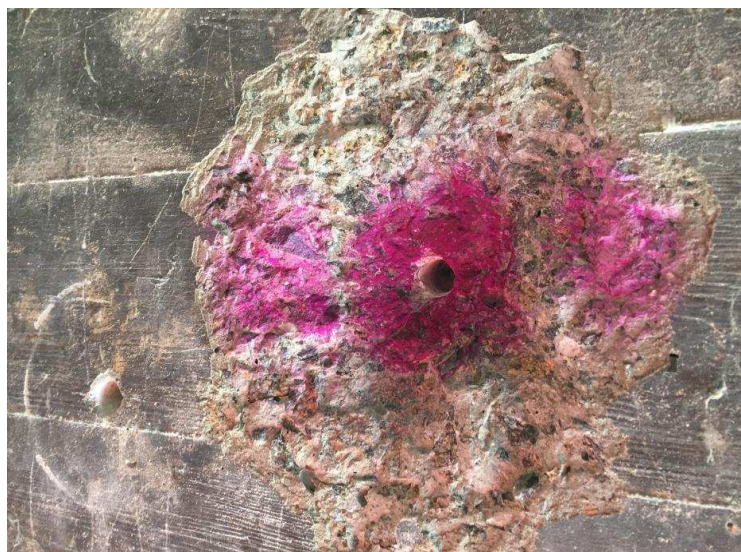
Рисунок 3 – Місце руйнування бетону після випробування методом відриву зі сколюванням на балці мосту через р. Сіверський Донець біля с. Старий Салтів.
