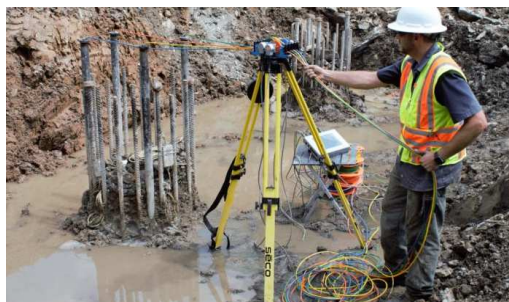
Рисунок 2 – Міжскважений аналізатор паль Champ-Q в роботі
