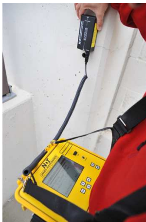
Рисунок 4 – Прилад для пошуку арматури Rebarscope
