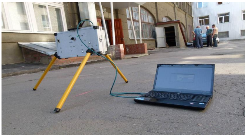
Рис. 1. Прилад для визначення шорсткості ПЛПШ-1
