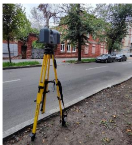
Рис. 2. Лазерний сканер Trimble TX6
