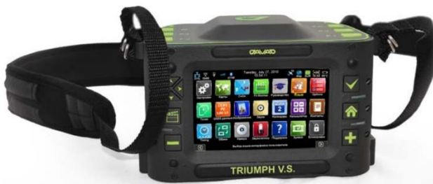
Рис. 1. Геодезичний ГНСС-приймач Javad Triumph-VS [1]
