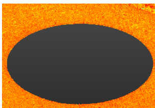
Рис. 2. Станція стояння сканеру у вигляді «мертвої зони»
