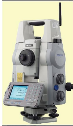
Рис. 2. Високоточний електронний тахеометр
