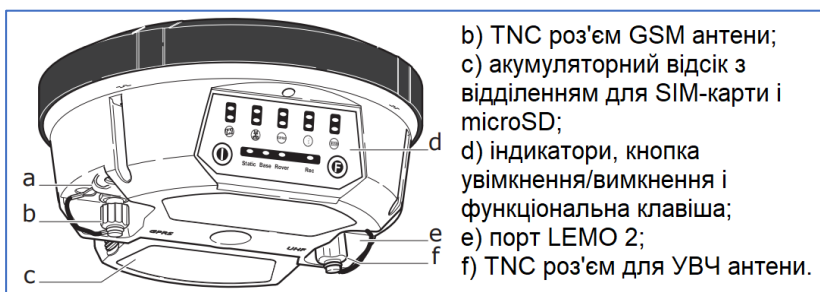
Рис. 1. Складові геодезичного інструменту Prexiso G4 GSM-UHF GNSS [1]
