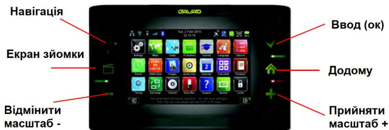
Рис. 2. Передня панель ГНСС-приймача Javad Triumph-VS [1]
