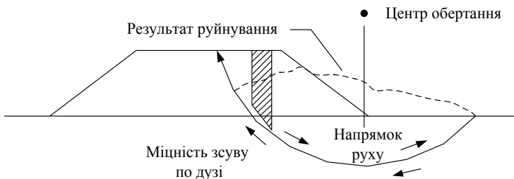
Рисунок 1 – Схема руйнування земляного полотна обертанням
