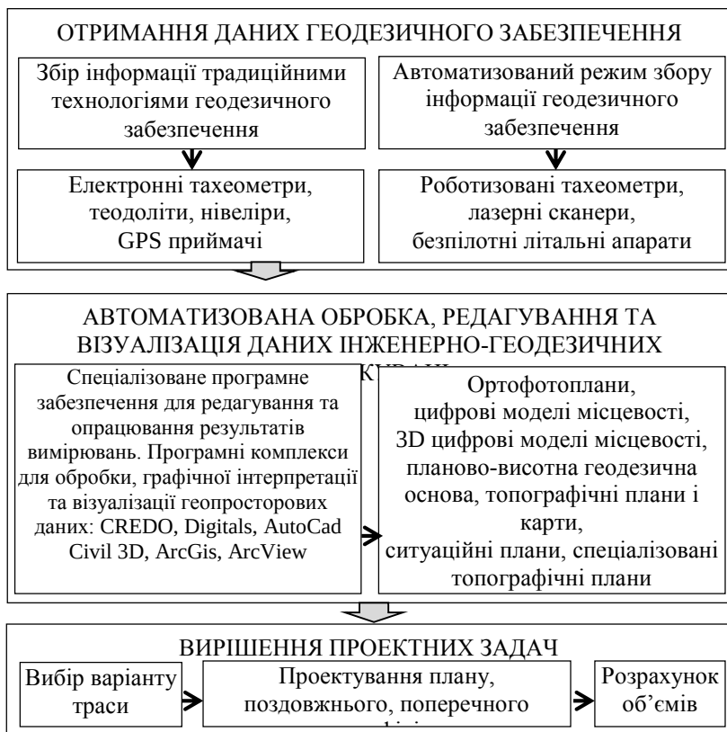
Рис. 1 – Геодезичне забезпечення проєктування автомобільних доріг
