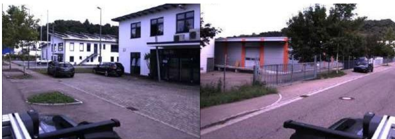
Рисунок 4 – Приклад відображення результатів вимірювань мобільним лазерним сканером Trimble MX2 у вигляді зображення на площині
