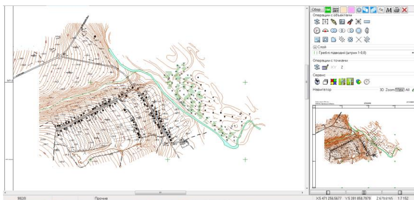
Рисунок 3 – Використання програмного забезпечення Digitals для побудови цифрового плану
