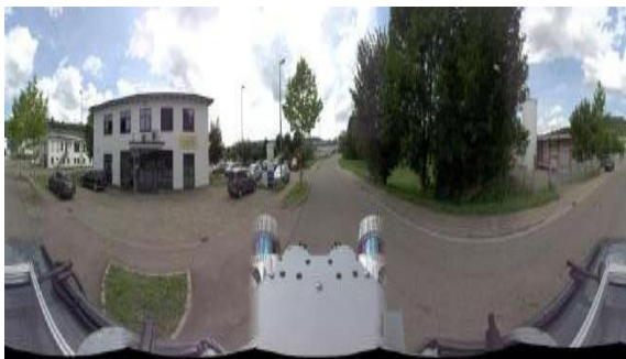
Рисунок 5 – Приклад відображення результатів вимірювань мобільним лазерним сканером Trimble MX2 у панорамного зображення
