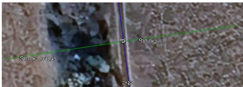
Рисунок 6 – Розбивка траси на точки перелому
