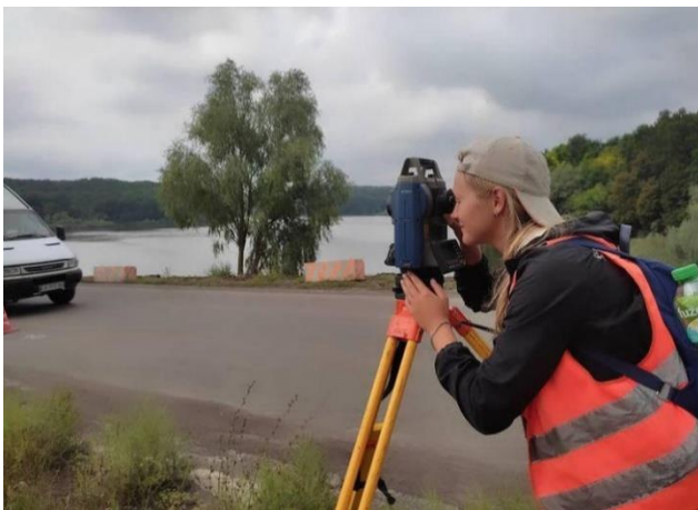
Рисунок 3 – Розбивка за допомогою електронного тахеометру
