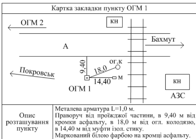
Рисунок 2 – Приклад картки закладки пункту опорної геодезичної мережі
