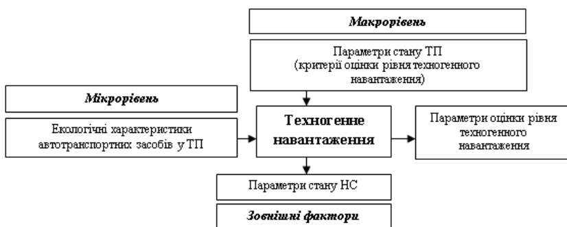
Рис. 1 – Формалізована схема розрахунку екологічних характеристик транспортних потоків
