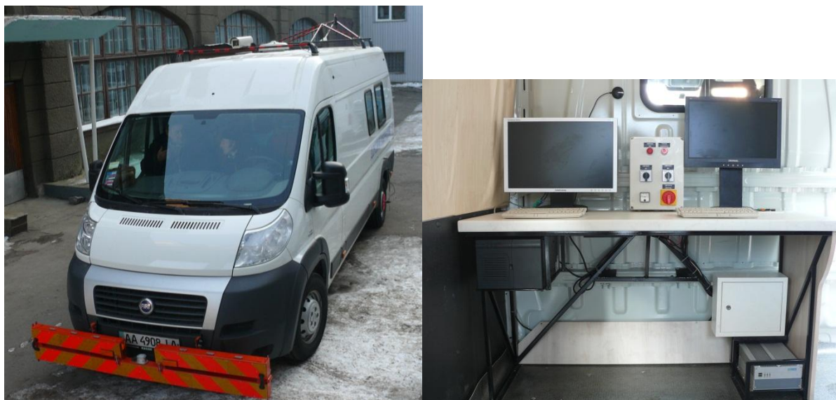
Рисунок 2 - Профілометр ЛВС-2-ХНАДУ на базі «Fiat Dukato»
