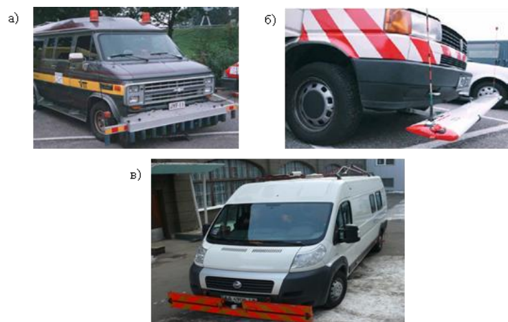
Рисунок 4 – Ходові дорожні лабораторії для сканування дорожніх покриттів безконтактними датчиками
