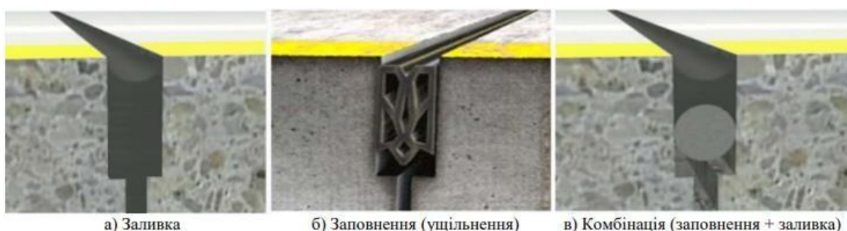
Рисунок 2 – Способи герметизації швів
