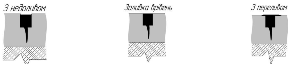
Рисунок 5 – Заливка герметика у тріщини
