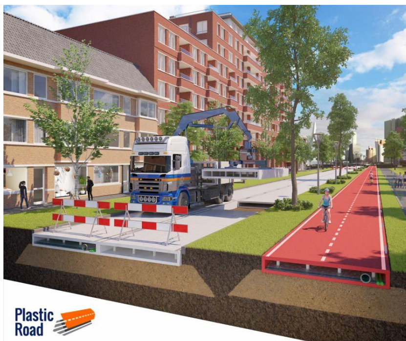
Рисунок 1– Схема інноваційного дорожнього покриття [5]
