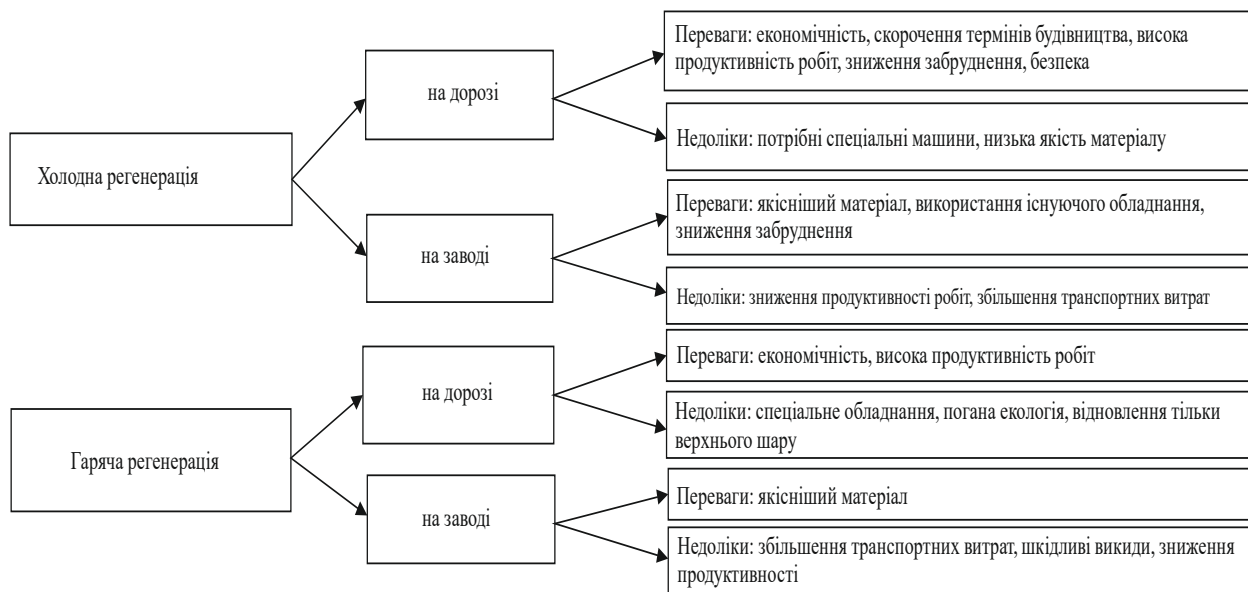
Рисунок 3 – Переваги та недоліки різних технологій регенерації.
