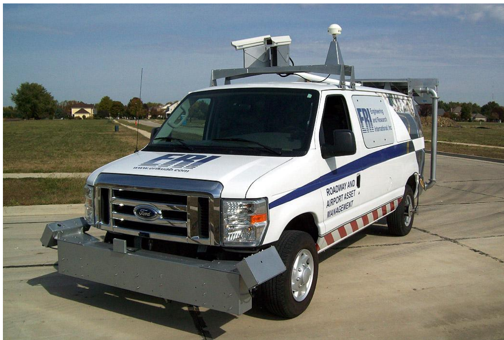
Рисунок 1 – Установка сканування покриттів штату Техас (США)
