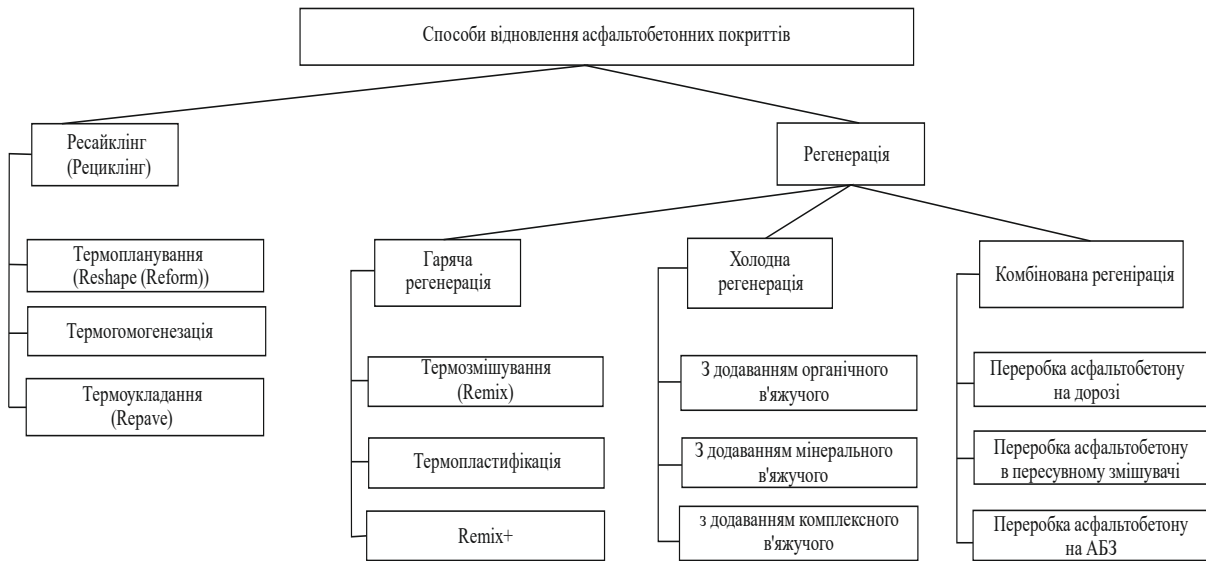
Рисунок 2 – Способи відновлення асфальтобетонних покриттів
