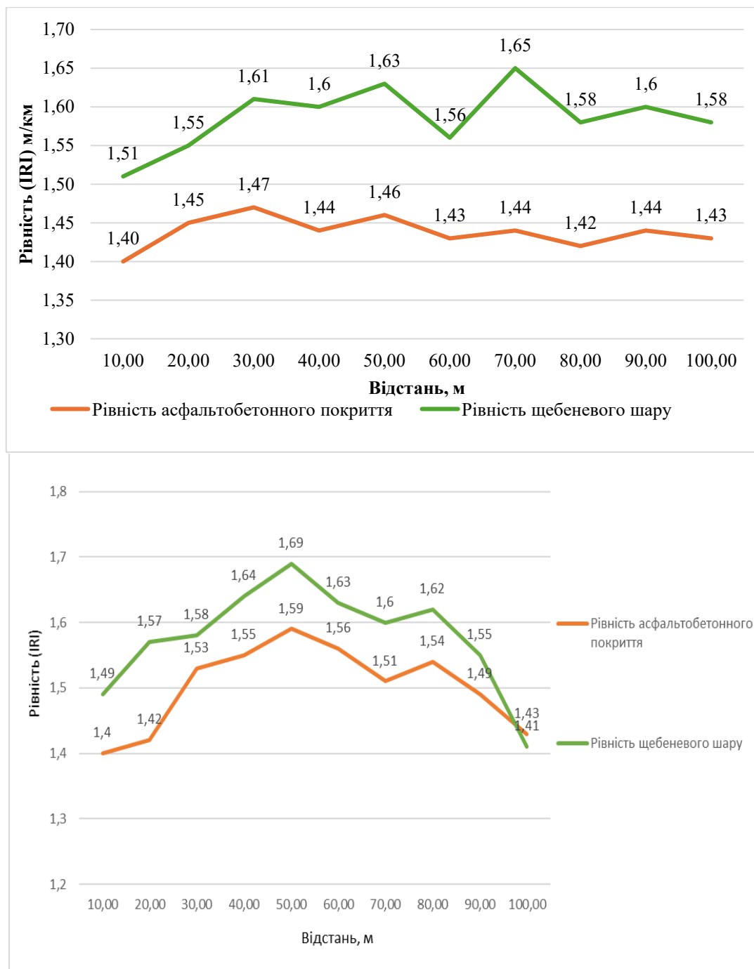
Рис. 3 – Порівняння рівності шарів дорожнього одягу
