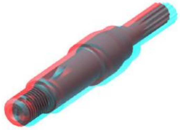
Рис. 2. Стереопари для отримання стереоскопічного зображення валу
