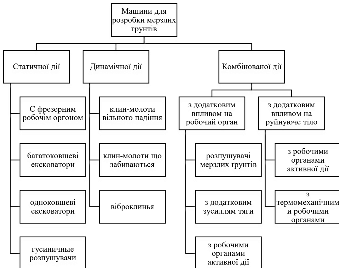
Рис.1. Класифікація машин для розробки мерзлих ґрунтів
