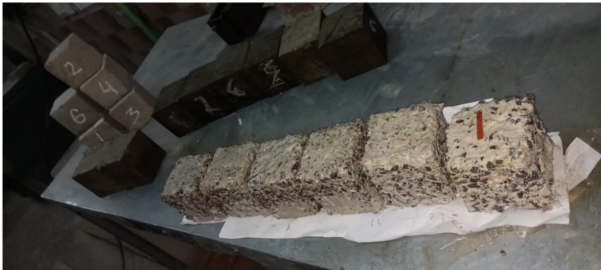
Рис. 1. Випробування зразків після дії агресивних впливів (2 – серія)
